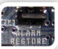
Jumper **ALARM RESTORE** (für die automatische Rückstellung) eingeschaltet: Der akustische Alarm und die Blinkleuchte (Mod. UNIT ALARM 2) schalten aus, wenn der Zustand, der den Alarm ausgelöst hat, behoben wurde.
