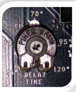
Con el trimmer **DELAY TIME** es posible configurar la duración (desde 20" hasta 120") después de la cual se desea la interrupción de la señal acústica y visual (si estuviera instalada la luz intermitente) de alarma automática.
