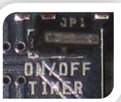
Cavalier **ON/OFF TIMER** (pour exclusion de la minuterie alarme) non activé : la sirène et le clignotant (mod. UNIT ALARM 2) continuent à fonctionner jusqu'à résolution de l'alarme.
