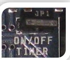
Jumper **ON/OFF TIMER** (per esclusione timer allarme) non inserito: la sirena e la lampada lampeggiante (mod. UNIT ALARM 2) continuano a funzionare fino a che la condizione di allarme non è risolta.
