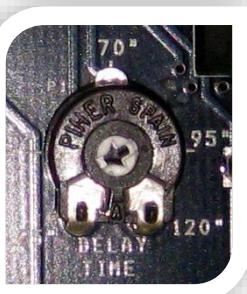
Le trimmer **DELAY TIME** permet de configurer le délai (de 20" à 120") après lequel la signalisation acoustique et visuelle (si le clignotant est installé) sera automatiquement interrompue.
