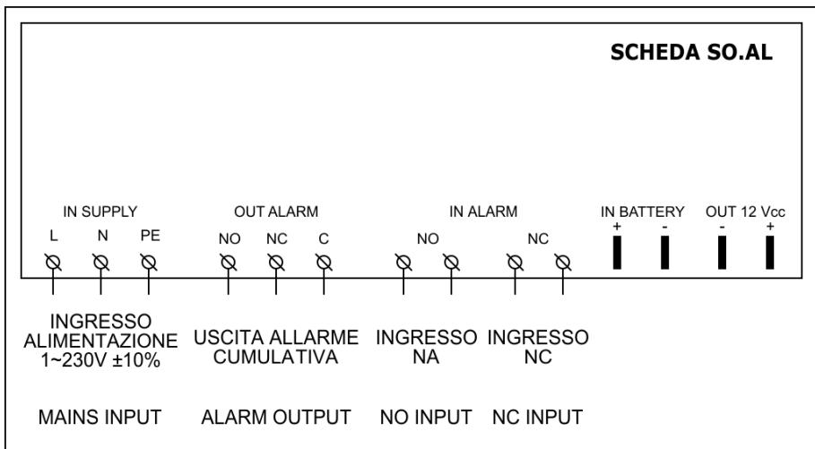
Les bornes NO et NF acceptent exclusivement des contacts secs, c'est-à-dire sans tension comme sorties alarme d'autres tableaux, flotteurs, pressostats, etc.
