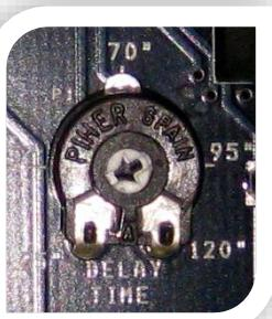
Mit dem Trimmer **DELAY TIME** kann die Dauer (von 20" bis 120") eingestellt werden, nach der die akustische Anzeige und Leuchtanzeige des Alarms (im Falle einer installierten Blinkleuchte) automatisch abstellen soll.
