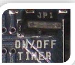
Jumper **ON/OFF TIMER** (zur Ausschaltung des Alarm-Timers) nicht eingeschaltet: Die Sirene und die Blinkleuchte (Mod. UNIT ALARM 2) funktionieren weiter, bis der Alarmzustand behoben ist.
