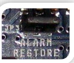
Jumper **ALARM RESTORE** (per il ripristino automatico) inserito: l'allarme sonoro e la lampada lampeggiante (mod. UNIT ALARM 2) cessano di funzionare quando la condizione che ha attivato l'allarme si è risolta.
