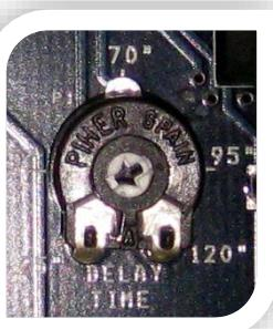
Con il trimmer **DELAY TIME** è possibile impostare la durata (da 20" a 120") dopo la quale si vuole l'interruzione della segnalazione acustica e visiva (nel caso sia installata la lampada lampeggiante) di allarme in automatico.
