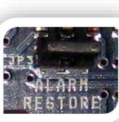
Jumper **ALARM RESTORE** (voor automatische reset) aangesloten: het geluidsalarm en het knipperlicht (mod. UNIT ALARM 2) worden onderbroken wanneer de conditie die het alarm heeft veroorzaakt, is opgelost.
