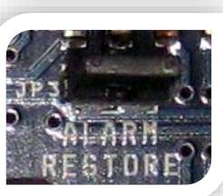
Jumper **ALARM RESTORE** (para el reajuste automático) conectado: la alarma acústica y la luz intermitente (mod. UNIT ALARM 2) dejan de funcionar cuando se resuelve la condición que ha activado la alarma.
