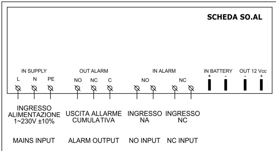
Die Klemmen NO und NC nehmen nur potentialfreie Kontakte an, in anderen Worten spannungsfreie Kontakte wie der Alarmausgang aus anderen Schaltkästen, Schwimmer, Druckwächter, usw.
