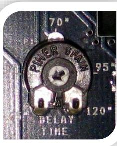
Met de **DELAY TIME** trimmer kan de duur worden ingesteld (van 20" tot 120") waarna de akoestische en visuele alarmsignalen automatisch worden uitgeschakeld (als het knipperlicht is geïnstalleerd).
