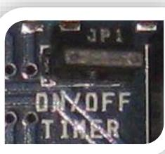
Jumper **ON/OFF TIMER** (voor het uitsluiten van de alarm-timer) niet aangesloten: de sirene en het knipperlicht (mod. UNIT ALARM 2) blijven werken totdat de alarmconditie is opgelost.
