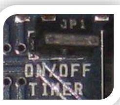
Jumper **ON/OFF TIMER** (para la desactivación del temporizador de alarma) no conectado: la sirena y la luz intermitente (mod. UNIT ALARM 2) siguen funcionando hasta que se resuelva la condición de alarma.
