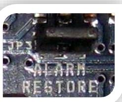
Cavalier **ALARM RESTORE** (pour réarmement automatique) activé : l'alarme sonore et le clignotant (mod. UNIT ALARM 2) cessent de fonctionner quand la cause de l'alarme a été résolue.
