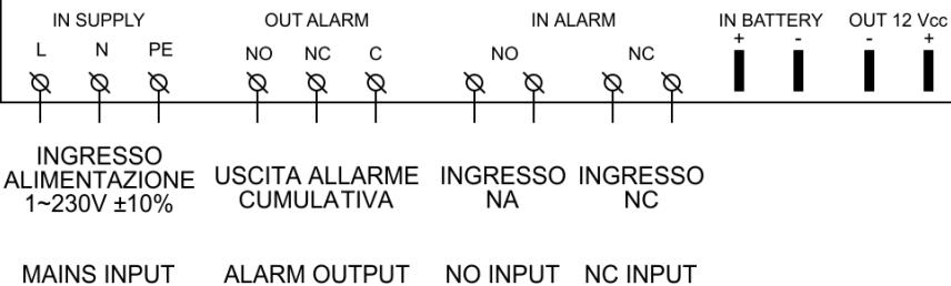
De klemmen NO en NC zijn droogcontacten, met andere woorden ze zijn zonder spanning als alarmuitgang voor andere panelen, vlotters, druckschakelaars, enz.
