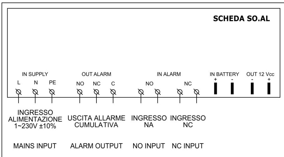
Los bornes NA y NC solo aceptan contactos secos, es decir, sin tensión como salida de alarma de otros cuadros, flotadores, presostatos, etc.
