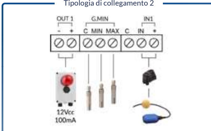
Tipologia di collegamento 2
