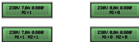
Questa schermata permette la visualizzazione generale dello stato motore e dell'impianto:
