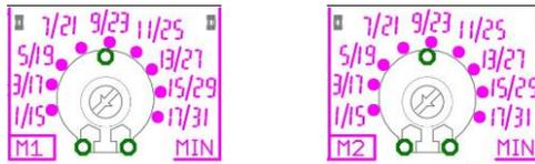
Mediante el trimmer «MIN» se puede regular la corriente mínima del motor para la protección contra el funcionamiento en seco en caso de que se desee una protección adicional o no se deseen utilizar sondas ni flotador de nivel mínimo.
