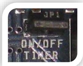
Jumper **ON/OFF TIMER** (per esclusione timer allarme) non inserito: la sirena e la lampada lampeggiante (mod. UNIT ALARM 2) continuano a funzionare fino a che la condizione di allarme non è risolta.
