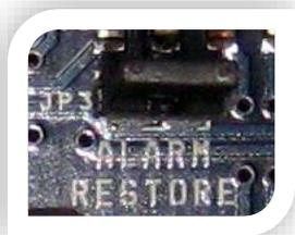
Jumper **ALARM RESTORE** (per il ripristino automatico) inserito: l'allarme sonoro e la lampada lampeggiante (mod. UNIT ALARM 2) cessano di funzionare quando la condizione che ha attivato l'allarme si è risolta.
