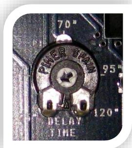
Con il trimmer **DELAY TIME** è possibile impostare la durata (da 20" a 120") dopo la quale si vuole l'interruzione della segnalazione acustica e visiva (nel caso sia installata la lampada lampeggiante) di allarme in automatico.
