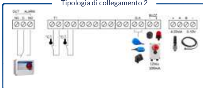
Tipologia di collegamento 2
