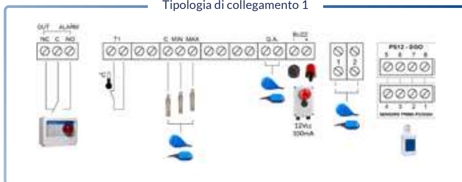
Tipologia di collegamento 1
